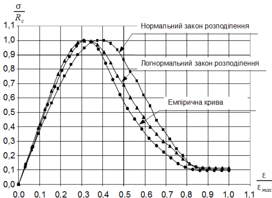
Рис. 6 – Криві деформування за межу міцності руди краско-мартитової
